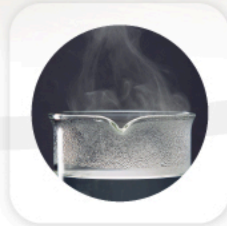
น้ำระเหยเป็นไอ น้ำ → ไอน้ำ (ขยาย 1,600 เท่า)
